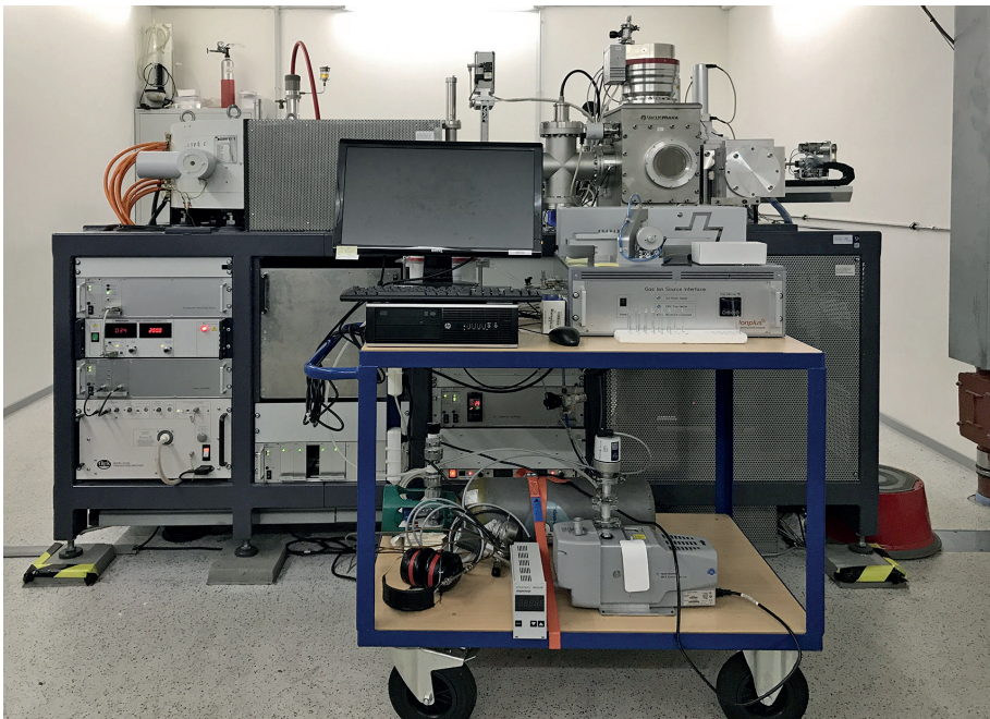
Im Klaus-Tschira-Labor für physikalische Altersbestimmung am CEZA in Mannheim befindet sich einer der modernsten Massenspektrometer (Typ MICADAS) zur ^{14}\text{C} -Datierung. (Foto: © W. Rosendahl)
